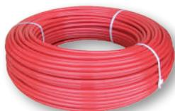
La tecnologia di fabbricazione del tubo Pe-xa permette di ottenere una reticolazione  $\geq$  al 75% durante il processo di produzione del tubo (mediante l'aggiunta di perossido) non sono quindi necessari altri trattamenti successivi. Il tubo Pe-xa è prodotto in conformità alla norma EN ISO 15875 con barriera di ossigeno (EVHO secondo la DIN 4726) nel rispetto della norma UNI-EN 1264-4 (Riscaldamento a pavimento: impianti e componenti, Installazioni)
