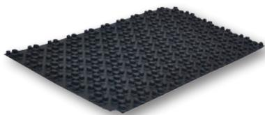
Pannello sistema Ultraslim senza isolamento per la posa di tubi Ø 10 mm. Grazie alla sua ridotta altezza permette impianti di riscaldamento in soli 20 mm, massetto compreso. La particolare conformazione delle nocche (tecnologia push-button), permette una facile e rapida posa dei pannelli e consente passi di posa multipli di 50 mm con la possibilità d'installazione del tubo in diagonale, direttamente sul pannello senza bisogno di ulteriori accessori.
